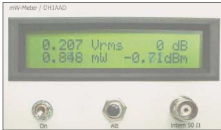
Bild 1: Durch das große LC-Display ist die gleichzeitige Anzeige des Messwertes als Effektivspannung und Leistung in mW und dBm möglich.
