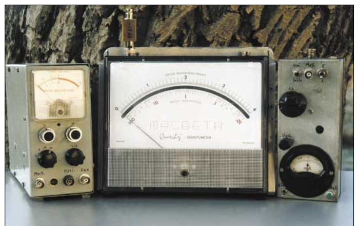
Bild 16: Die drei Testgeräte (v.l.n.r.): Das große Zeigerinstrument des zweiten Geräts ist ideal für die Anzeige von Rückflussdämpfungen.
