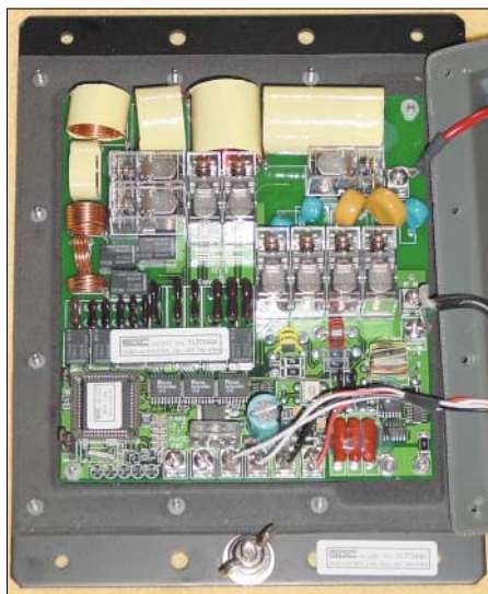
Bild 2: Blick in das geöffnete Gehäuse des SG-237 mit der Tunerplatine
