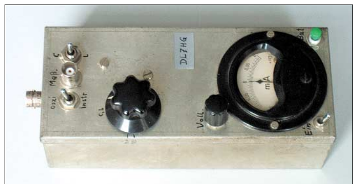
Bild 14: Das dritte Gerät verfügt über ein Messinstrument, bei dem der Nullpunkt in der Mitte liegt. Fotos: DL7HG
